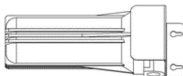
Filtre et réduit la quantité de calcaire dans la chaudière pour en accroître la durée de vie.
