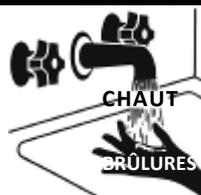
Les températures de l'eau supérieures à 52 °C (125 °F) peuvent provoquer des brûlures ou des échaudures graves, voire mortelles.
