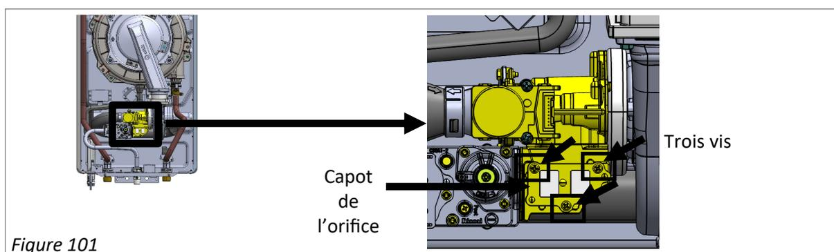
8. Retirer l'orifice en plastique du boîtier (figure 102).
