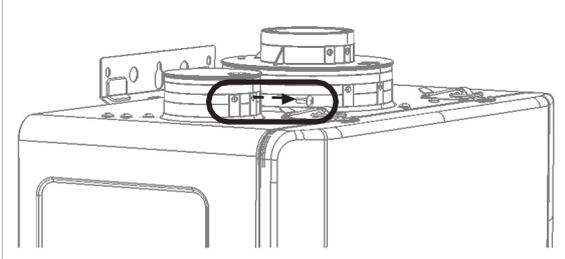
2. Déposer et mettre au rebut le cache de prise d'air comburant.
