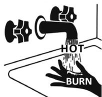
Une température d'eau supérieure à 125° F (52° C) peut causer des brûlures graves ou des échaudures menant à la mort.
