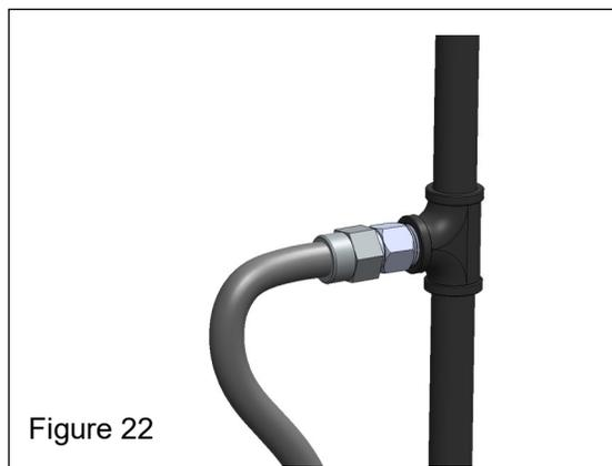
5. Tester l'étanchéité de TOUS les raccords et assemblages de gaz en utilisant une solution de test d'étanchéité, de l'eau et du savon, ou une solution ininflammable équivalente.
