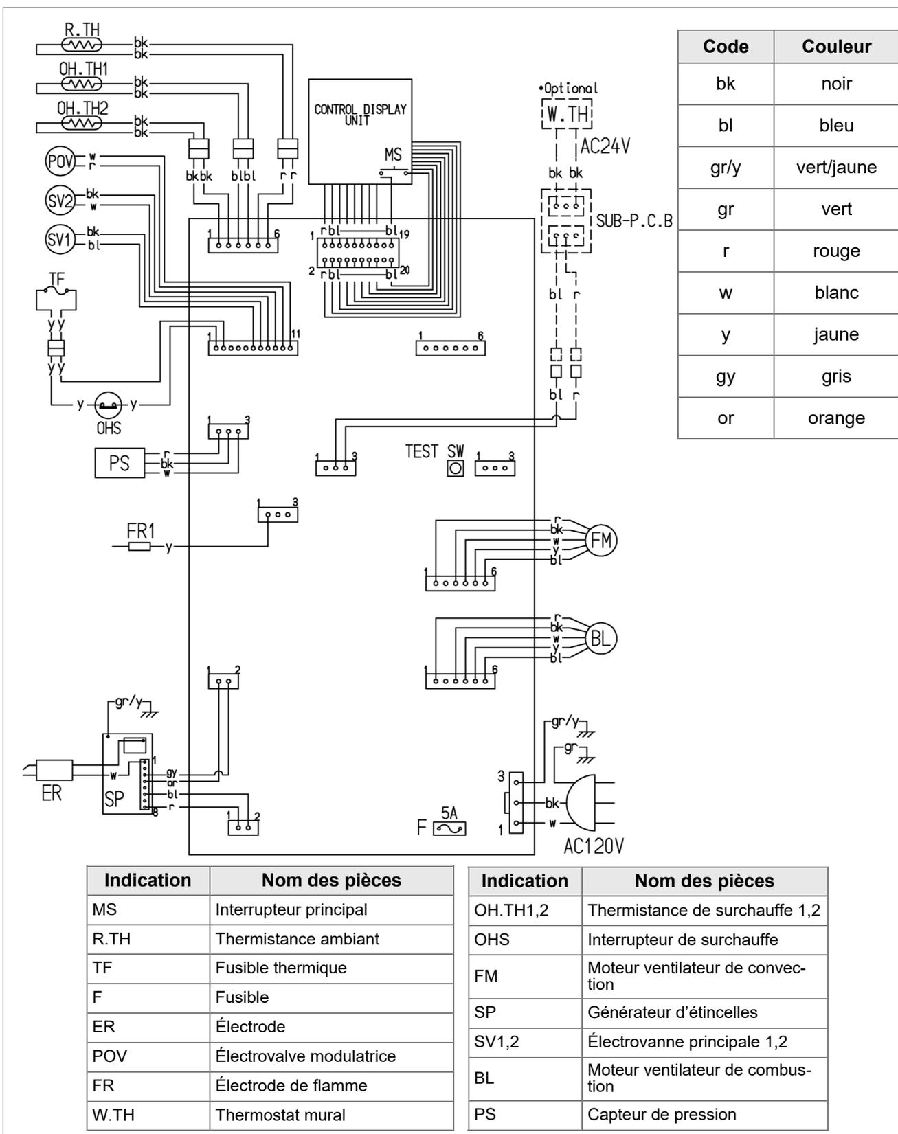
Figure 59: Schéma de câblage
