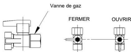
6. Attendez cinq (5) minutes pour laisser le gaz restant s'échapper. Puis renifler pour détecter du gaz, ne pas oublier pas les zones proches du sol. En cas d'odeur de gaz, STOP! Suivre le point B des informations de sécurité ci-dessus. Si aucune odeur de gaz n'est détectée, passer à l'étape suivante.
